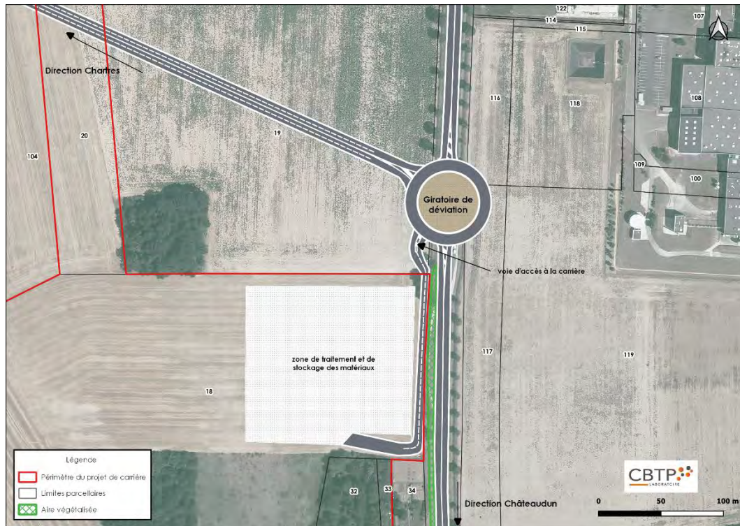
Figure 46 : tracé possible de l'accès à la carrière modifié par le tracé XE de la déviation de la RN 10
